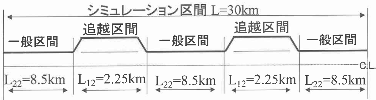
図-1 短い4車線区間の設置例(ケース2)
