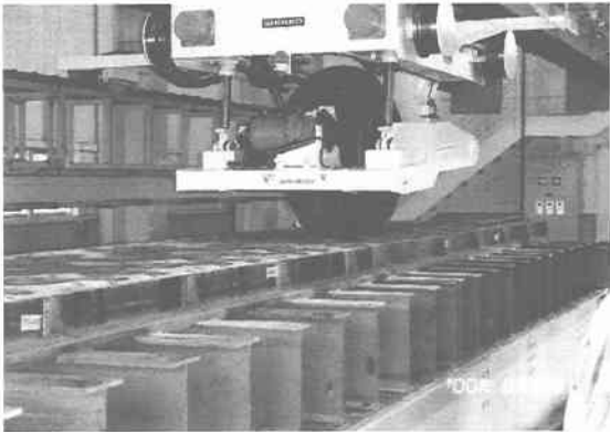
図－10 移動載荷試験の状況
