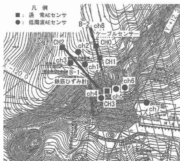
図-1 雷電トンネル終点斜面のAEセンサ配置状況(左:平面図、右:断面図)
