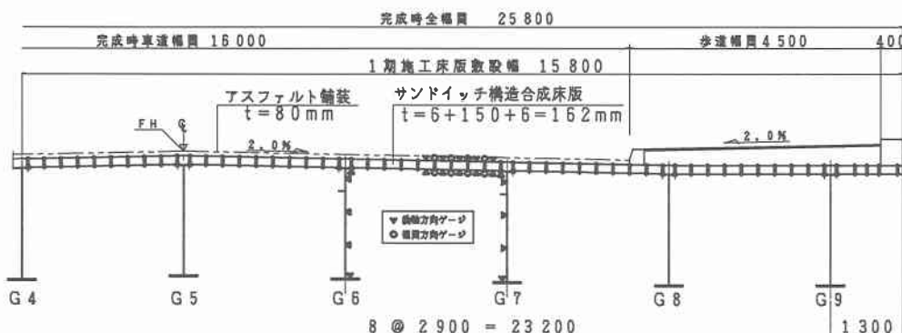
図-5 礼文塚橋の断面および計測位置（単位：mm）
