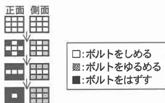
図-2 ボルトの固定状態(ケース 1)
