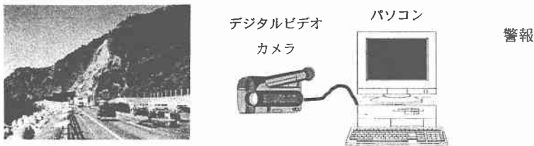
図 1. 落石検知用自動映像検知システム概要
