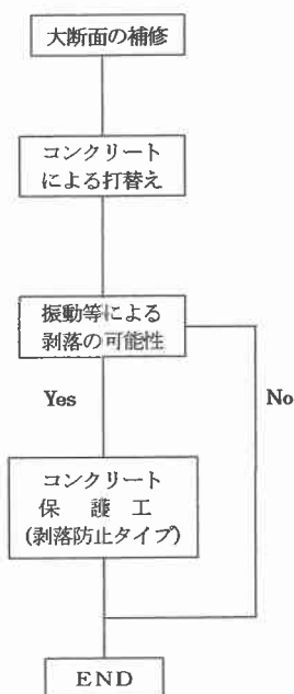
図－４ 大断面補修方法フローチャート
