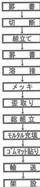
図-4 埋設ジョイント製作手順
