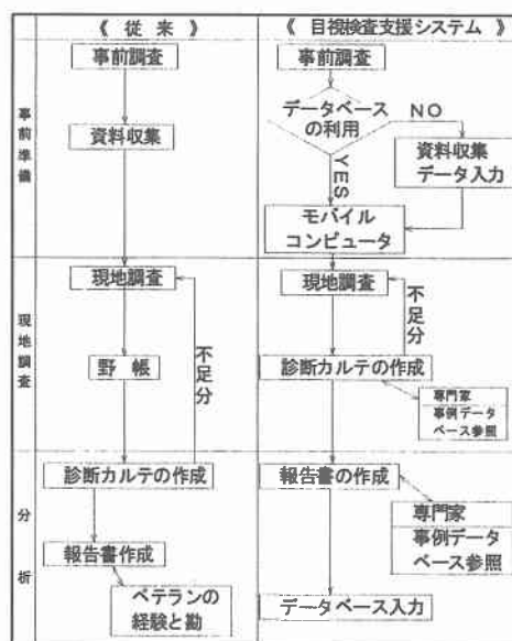
図-6 目視検査の流れ
