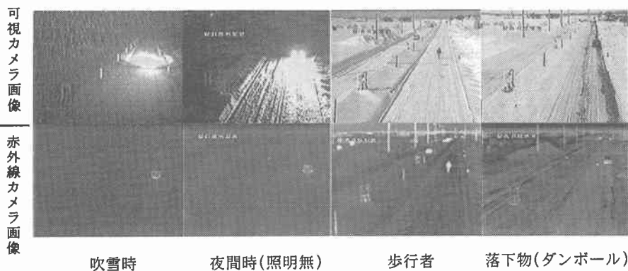
図-6 可視カメラ画像と赤外線カメラ画像の比較
