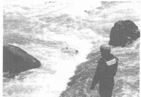
写真-3 段差によるバックウォッシュに巻き込まれた人体模型 (流量大)
