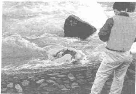
写真-5 護床ブロックの隙間に足がはさまり停止した人体模型 (流量大)
