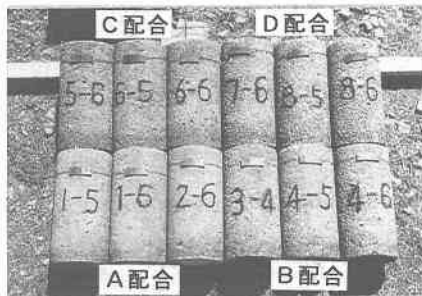
写真-3(b) 圧縮強度試験用供試体の外観
