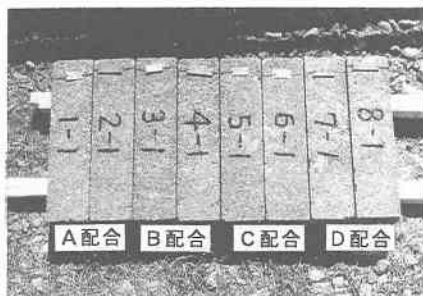
写真-3(a) 凍結融解試験用供試体の外観
