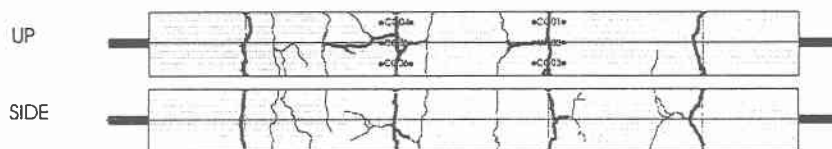
図-2.1 ひび割れ図(CS-00)
