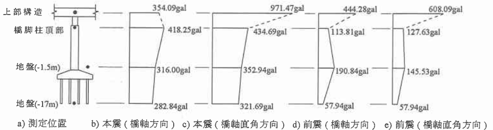
図-2 1994 年北海道東方沖地震による橋梁各部の加速度測定値の最大値の分布
