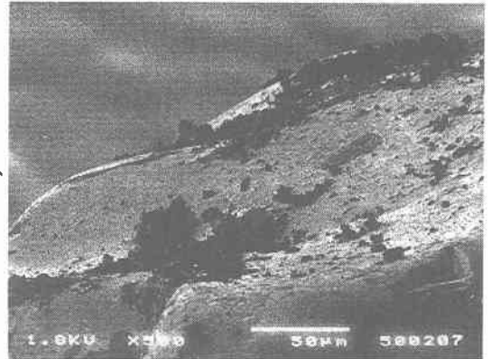
写真1 珪砂表面に捕捉された濁質(黒色の堆積物) (下向流ろ過10分後、写真上部が上流側)
