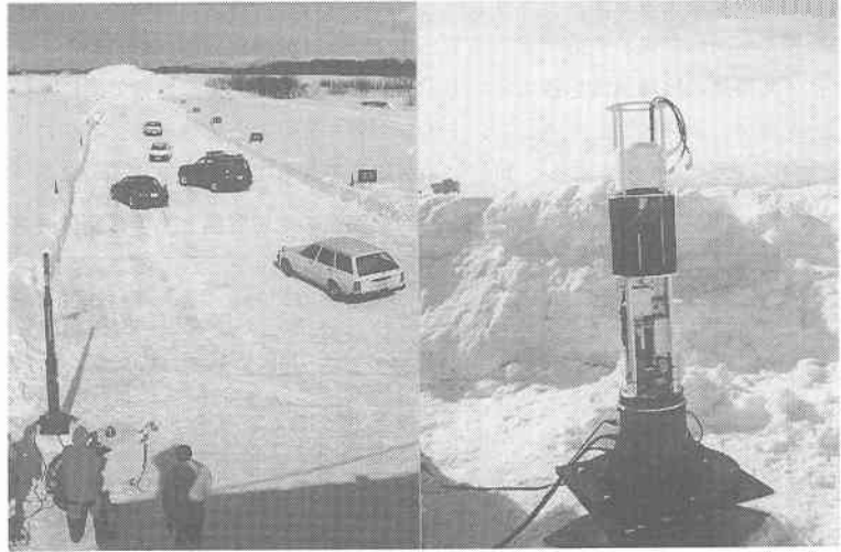
写真-1 インテリジェント・デリベータ・システムの実験状況と試作したミリ波による停止車両検知用レーザ
