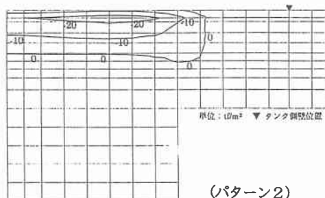
図-14 改良地盤内部応力コンター図 ( \sigma_3 )
