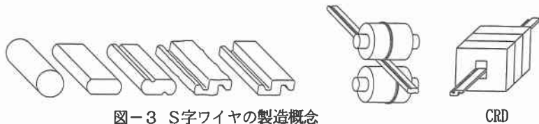
図-3 S字ワイヤの製造概念
