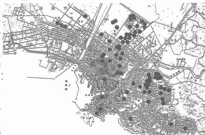
図-4 北海道東方沖地震における下水道管渠の被害箇所
