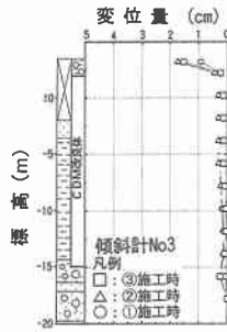
図-12 傾斜計観測結果(改良体)
