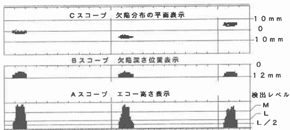
図. 3 ダイナミックキャリブレーション試験体の探傷結果
