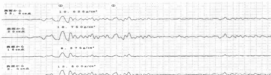
図-5 動的土圧の実験記録
