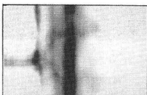
図3 スラグ巻込みの画像、マクロ組織写真及びX線写真
