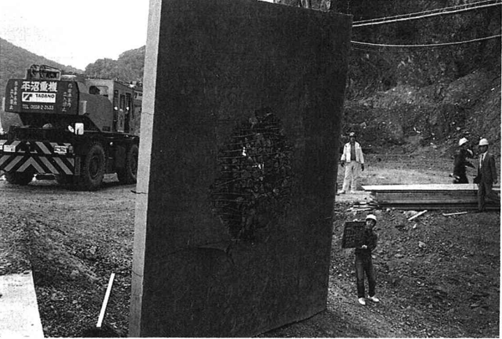
写真-3 実験後の芯材RC版
