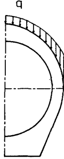
等分布荷重載荷モデル 図-5
