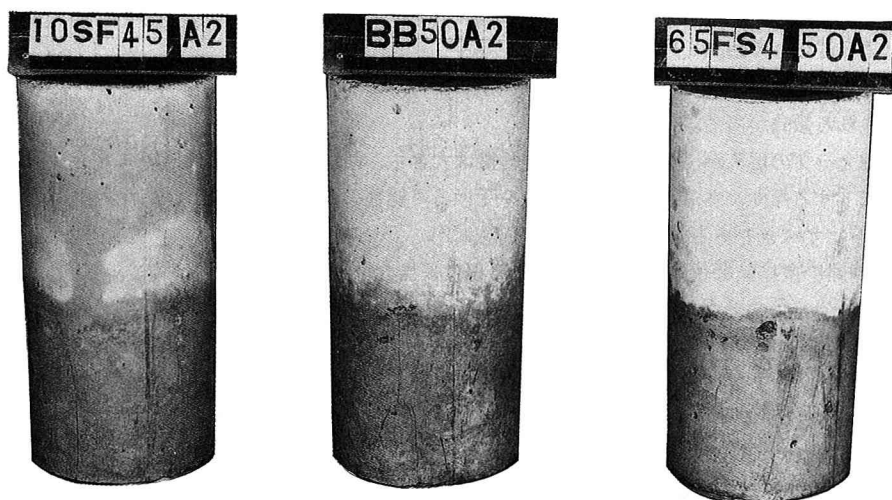
写真-1 供試体の凍害状況
