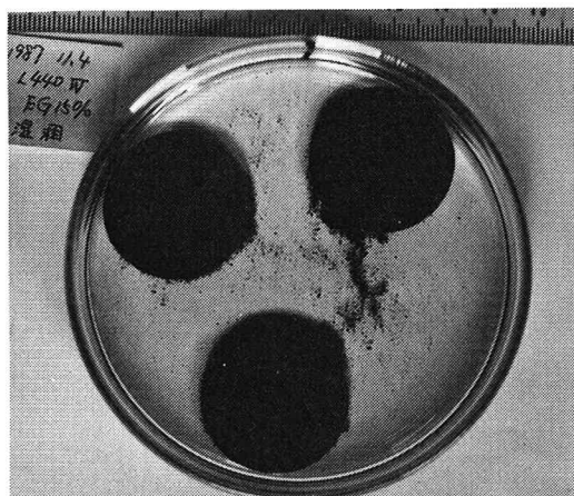
写真2 変質紫そ輝石普通輝石安山岩の 供試体をエチレングリコール15% 水溶液に浸して35日間経過後 の崩壊状態
