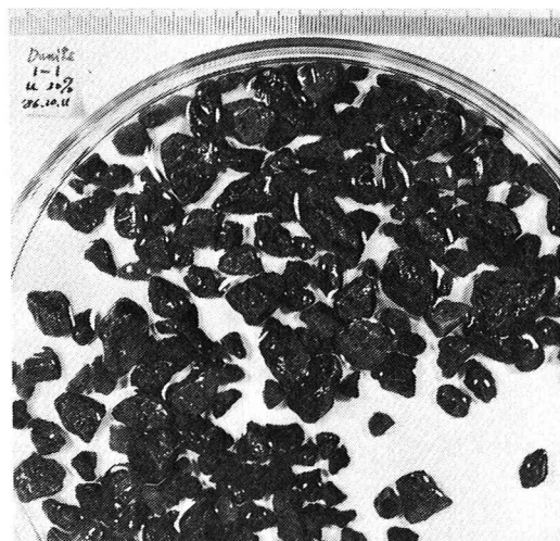
写真-3 かんらん岩の道路用碎石を \text{CO}(\text{NH}_2)_2 30% 溶液に 浸して20日間経過後の状態
