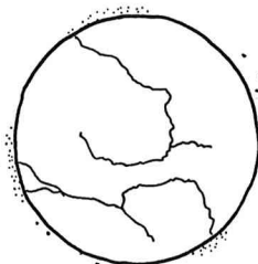
第1図 \text{CH}_3\text{COOH} 60%溶液による26日間 乾湿繰り返しによる普通輝石紫そ 輝石安山岩供試体の崩壊状態の スケッチ
