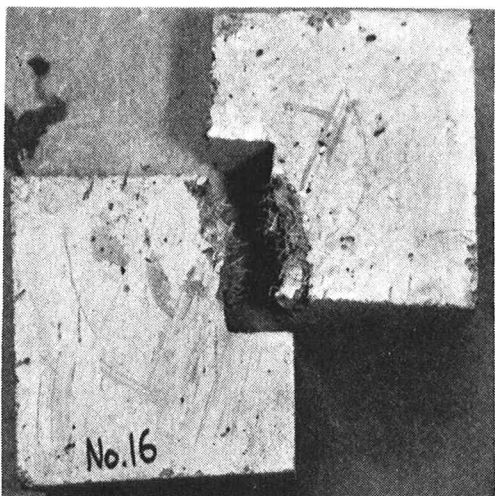
写真-7 試験後の供試体(SFRC)
