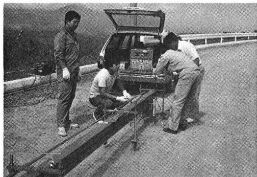
写真-2 路面プロフィールメーター
