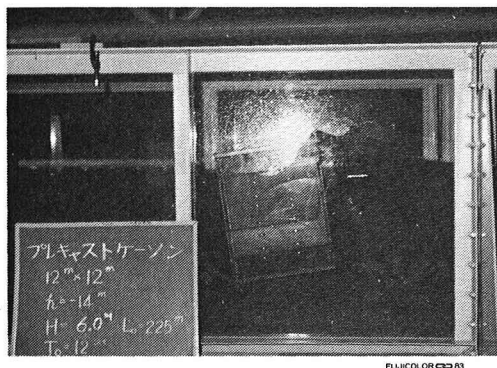
写真-1 H=6.0\text{m} (ケーソンの後趾にてマウンドが破壊しはじめた)
