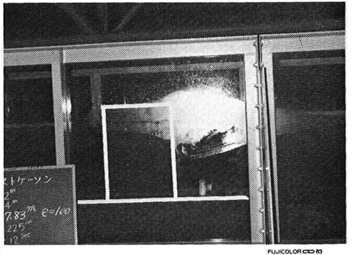
写真-7.2 H=7.83\text{m} (エレメントを一体化した場合、波谷時)
