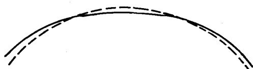
对称振動 2 次 T_2 = 0.951 \text{ sec.}
