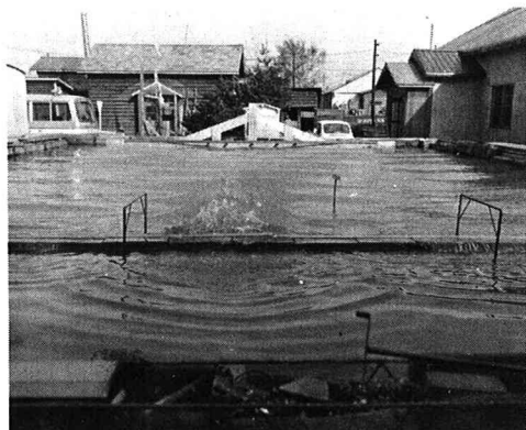
写真一 防波堤設置時の波高 (W波, H_o = 3.4 m, T = 7.5 sec, H.W.L.)
