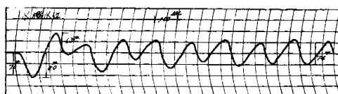
圖-15 雨前差動水槽出力 0~15 MW 周期 170 秒梯形波形
