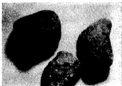
写真一 6 F 骨材 I スリヘリ試験結果
