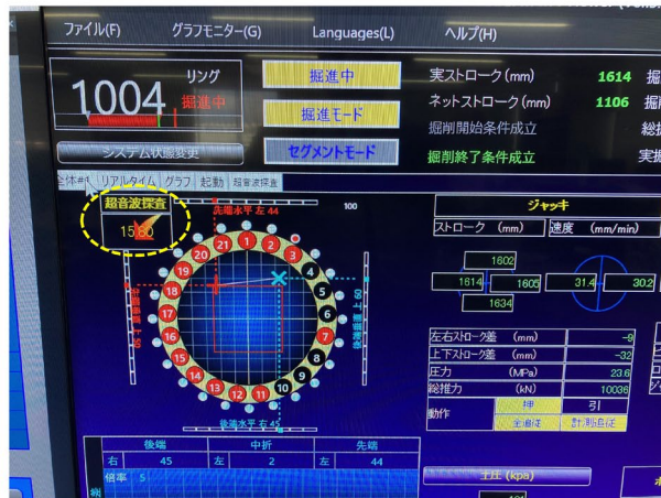
図5 地山崩壊探査装置（超音波式）の管理画面
