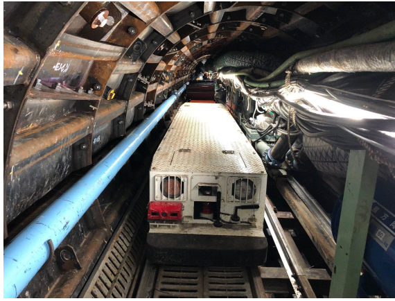
写真-1 超低空頭セグメント搬送台車（自走牽引台車）
