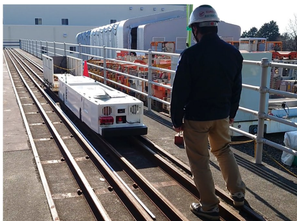
写真-5 A パターン制動確認
