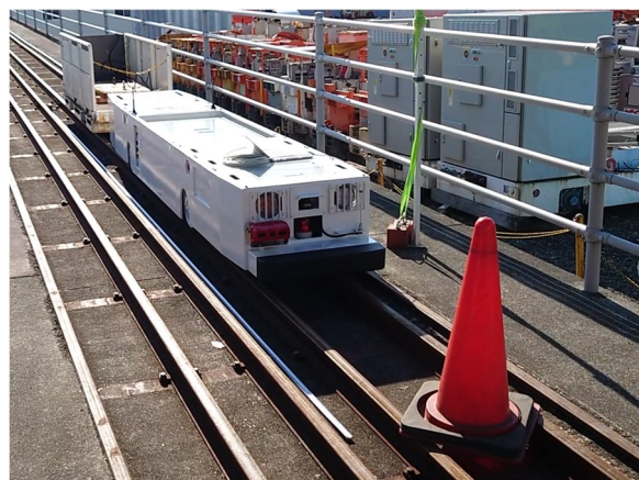
写真-7 C パターン制動確認
