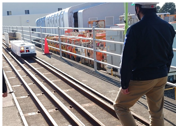
写真-6 B パターン制動確認
