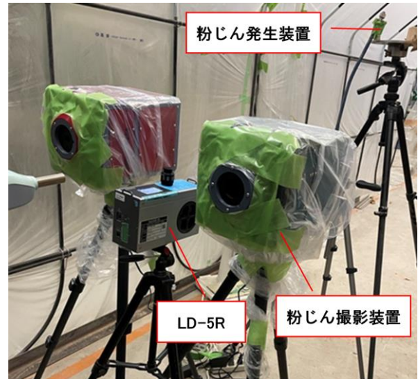
図-7 撮影装置とデジタル粉じん計 LD-5R および粉じん発生装置の配置図
