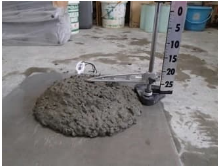
写真-12 中流動コンクリート
