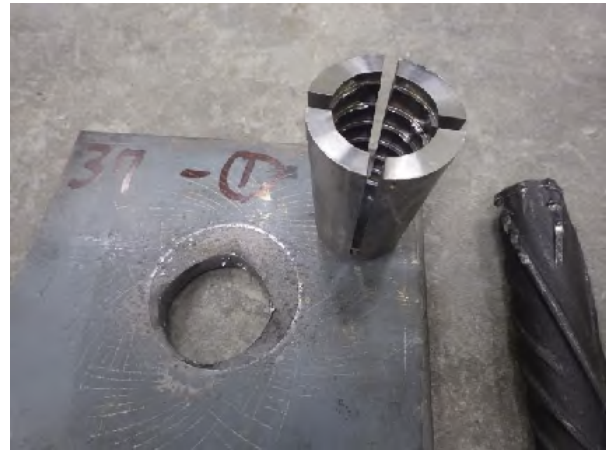
写真8 くさび方式での破壊状況（ねじり棒鋼）
