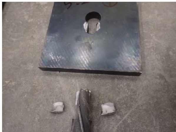
写真-10 スリット方式での破壊状況 (ねじり棒鋼)
