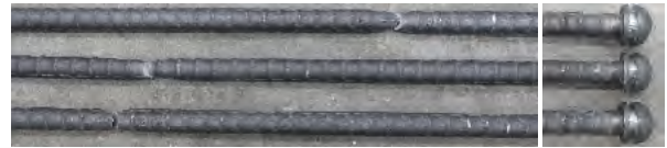
写真-12 外みぞ方式での破断状況 (異形棒鋼)
