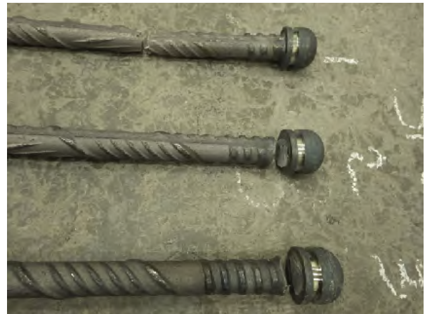
写真-14 外みぞ方式での破断状況 (ねじり棒鋼型異形棒鋼 高耐力ボルト)
