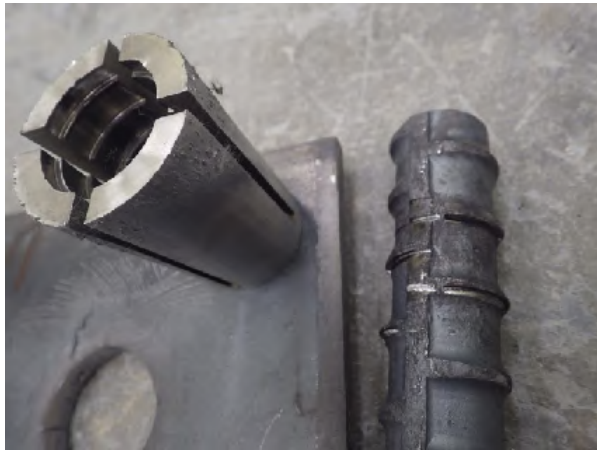
写真7 くさび方式での破壊状況（異形棒鋼）
