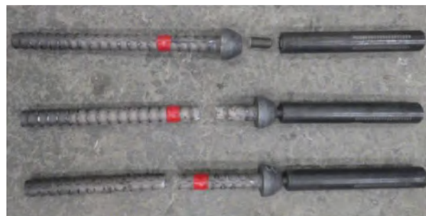
写真-11 内ねじ方式での破断状況 (ねじり棒鋼)
