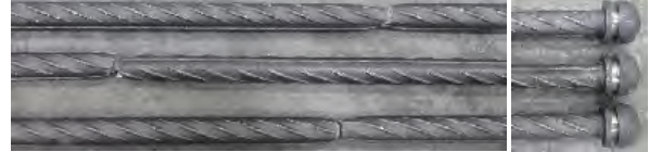
写真-13 外みぞ方式での破断状況 (ねじり無しねじり棒鋼)
