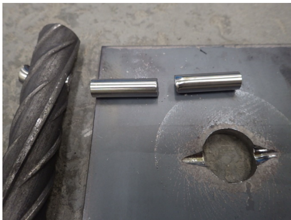
写真-6 割りピン方式における代表的な破壊状況
