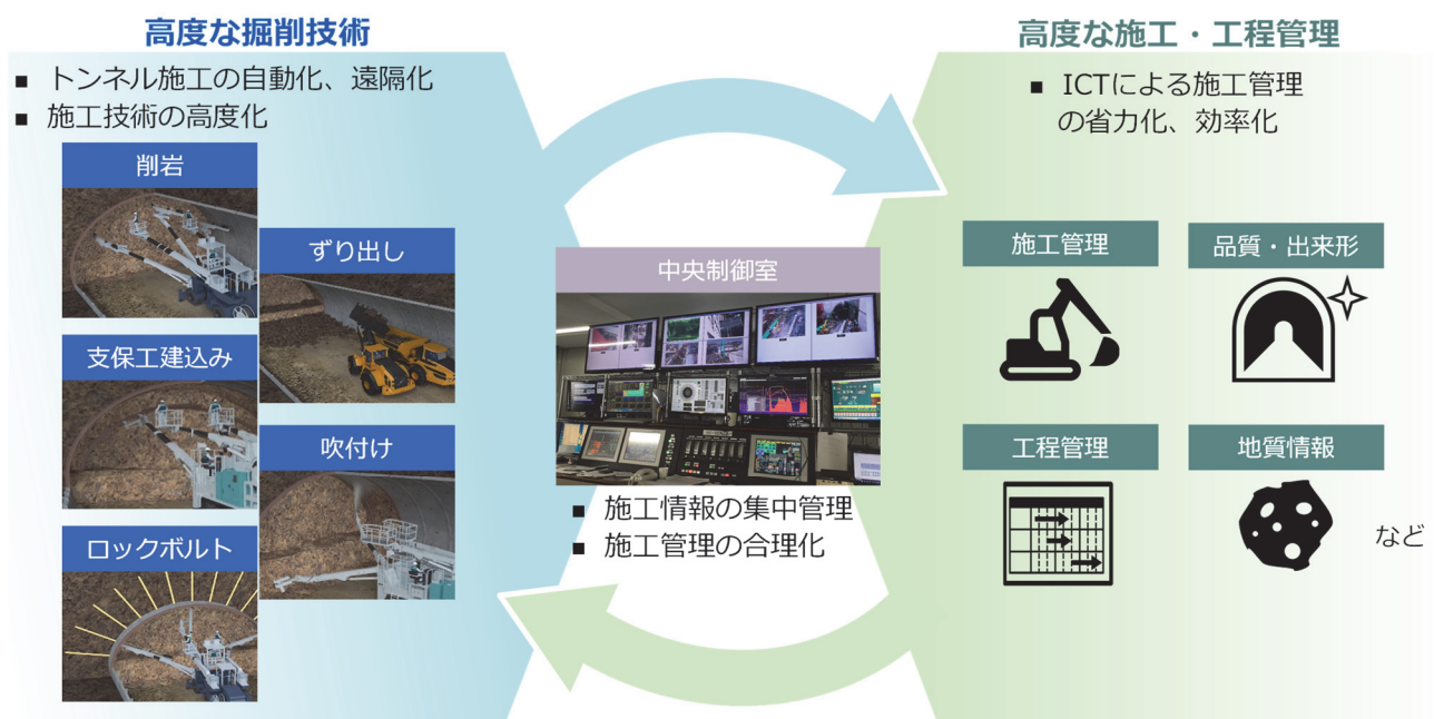
図-1 山岳トンネル統合型掘削管理システム（i-NATM®）
