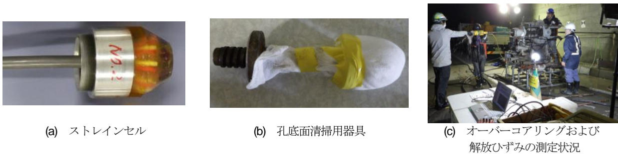
図-4 現場測定状況
