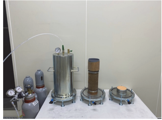
図-6 室内透水試験の状況
