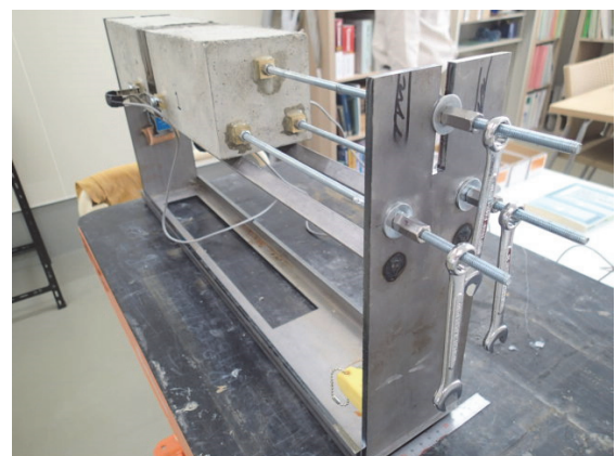
図-4 追従性確認試験の状況
