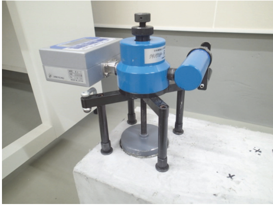
図-5 室内建研式付着試験の状況
