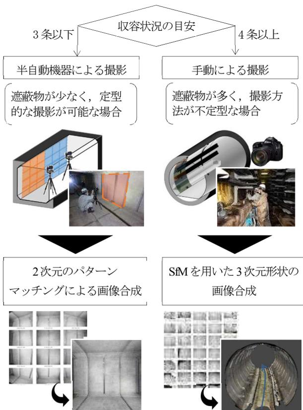
図-4 画像撮影と合成処理の選定条件
