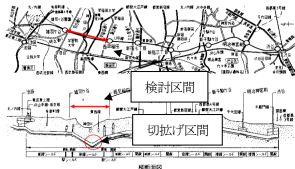
図-1 東京メトロ副都心線平面・縦断図
