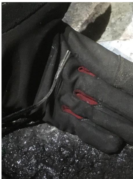
図-27 接着剤が剥離した測点2のRRセンサー
