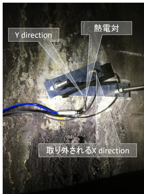
図-16 モニタリング様式を②にするためにボックスを取り外した様子
