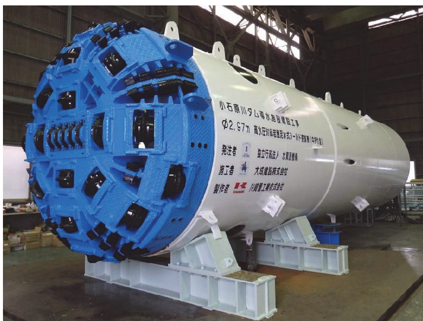
写真-1 φ2.970 泥水式岩盤シールド
