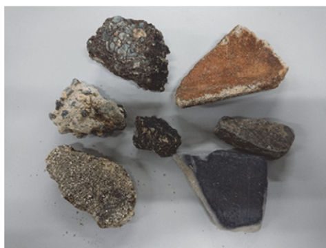
写真-1 掘削土に混入して排出された瓦礫
