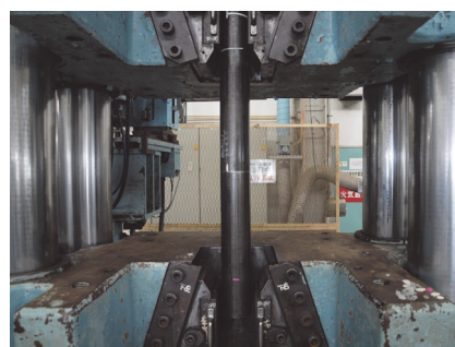
写真-3 引張試験実施状況
