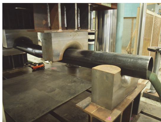
写真-2 曲げ試験実施状況
